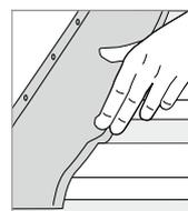
5. Ajuste manualmente DEKTITE® à forma da chapa perfurada. Não use ferramentas.
