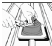
1. Ajuste o DEKTITE® ao tubo.
