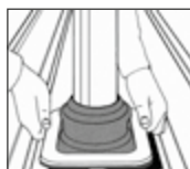
2. Ajuste o DEKTITE® à chapa perfilada e faça a marcação.
