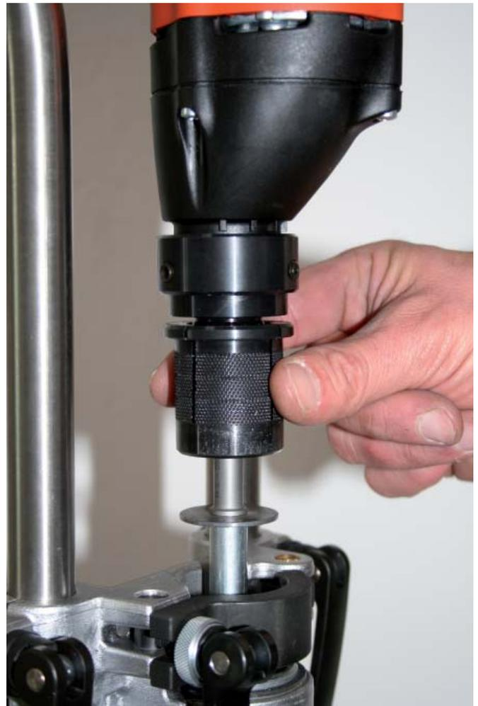
Recoloque a unidade de acionamento exatamente no adaptador da máquina. Trave a liberação rápida.
