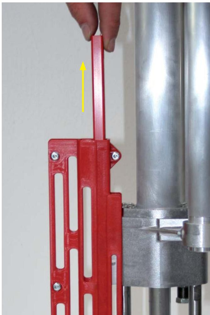
O cartucho de controle e o eixo de alimentação devem procurar parafusos remanescentes de processos de fixação anteriores. Remova-os!
