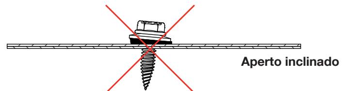
Se você tiver controlado o posicionamento correto do parafuso, ligue a fonte de alimentação e continue a fixação conforme descrito nas diretrizes de processos.
