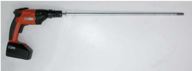
Insira a chave de soquete tamanho 8 inclusa na cabeça da porca e trave o eixo de acionamento no local adequado com a chave A/F 10 inclusa.
