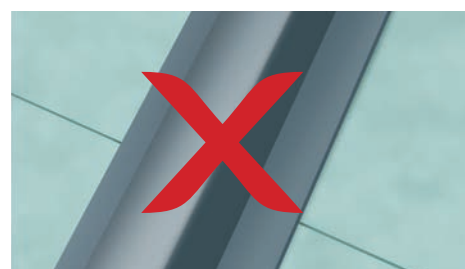
Não instale o EJObar sobre a solda, sem usar uma tira de cobertura de membrana adicional.
