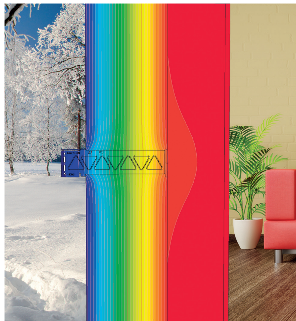
Imagem 2 Ponte térmica mínima com o CROSSFIX®
