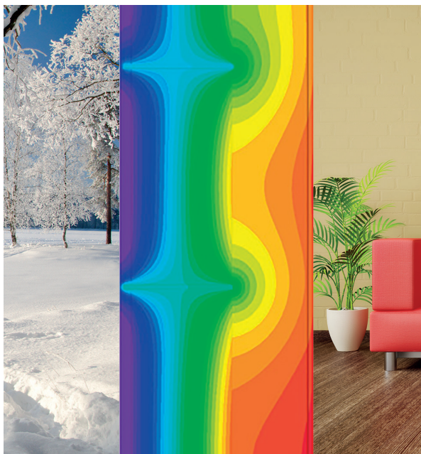
Imagem 1 Ponte térmica pronunciada em consoles de alumínio
